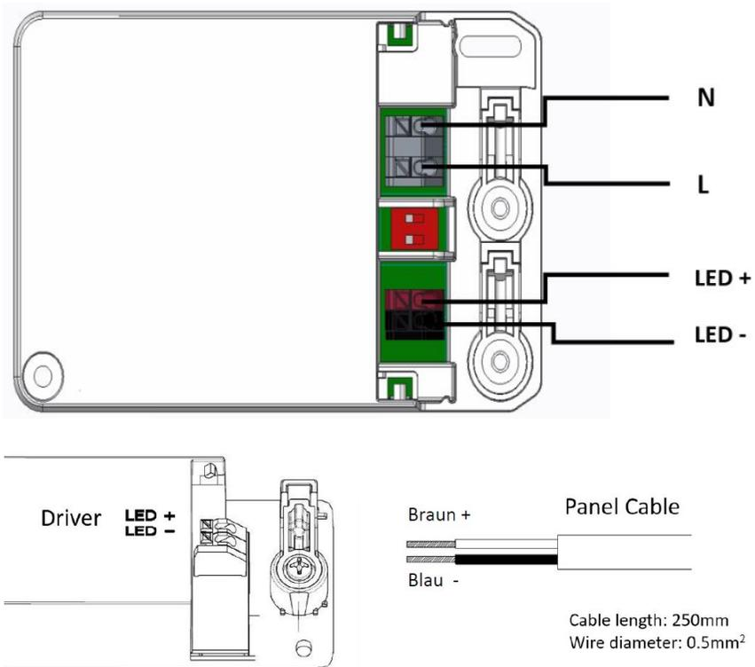
Anschlusskabel des Panels muss über eine Zugentlastung abgesichert sein.
