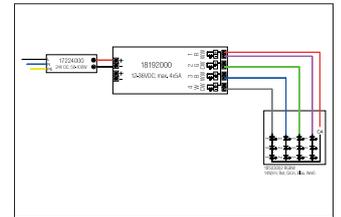
RGBW-Funkfernbedienung zu 18192000 RGBW-Funkfernbedienung zur Ansteuerung von RGBW-LED-Modulen für Farb- und Weißlicht.
