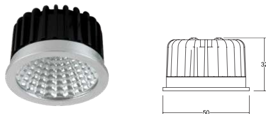
LED-Reflektoreinsatz MR16, 6 W, 350 mA, CRI > 80
