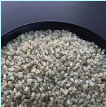
Herstellung eines qualitätskontrollierten Kunststoffgranulats zur Weiterverarbeitung.
