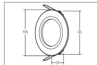
LED-Wandeinbauleuchte, strukturweiß, rund. Einbaumontage, Wandmontage. Zum Einbau in Hohlwände mittels Schenkelfedern.
