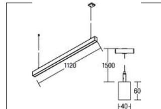
LED-Pendelprofileuchte BIRO40, satinierte Abdeckung, aluminium. Ausführung in kompakter Bauform für die harmonische Implementierung in stimmige, architektonische Raumkonzepte.
