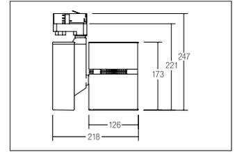
LED-Schienenstrahler, 40W, schwarz. Ausführung in kompakter Bauform für die harmonische Implementierung in stimmige, architektonische Raumkonzepte.
