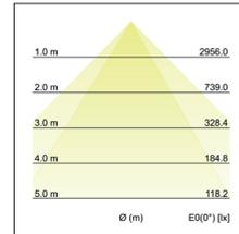
LED-Einbauprofil BIRO40, silber, rechteckig. LED-Lichtkanal mit microprismatischer Abdeckung. Ausführung: LED, Montageart: Einbaumontage, Montageort: Deckenmontage, Material: Aluminium / Acryl, Schutzart: nach DIN EN 60529: IP20, Schutzklasse: (EN 61140) I, Spannung: 230V AC 50Hz, Leistung: 17,9W, Lichtstrom: 1.430lm, Farbtemperatur: 3000K, Lichtfarbe: weiß, Abstrahlwinkel: 80°, Verstellbarkeit: nicht verstellbar, mit Betriebsgerät.
