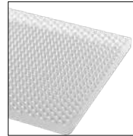
Acrylabdeckung Mikroprisma flächenbündig. Für gerichtetes Licht mit reduziertem Streulichtanteil und Entblendung.
